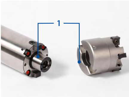
1. Den Aufnahmebereich des Aufsteckfräserdorns und des Werkzeugs reinigen (1).
