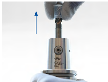
2. Das Werkzeug aus der Aufnahmebohrung des Flächen-spannfutters entnehmen.
