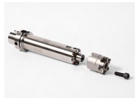
3. Das Werkzeug vom Fräseraufsteckhorn entnehmen.
