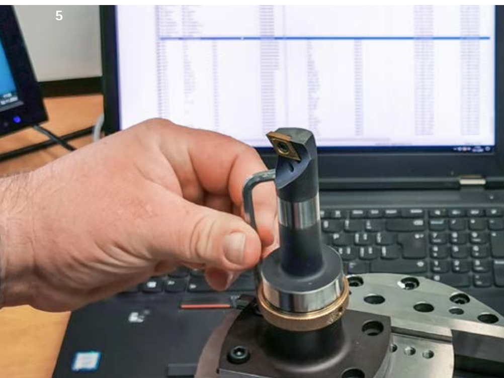
4 Die TOOLTRONIC mit linearem Aussteuerwerkzeug wird über die HSK100-Schnittstelle an der Spindel eingewechselt.
