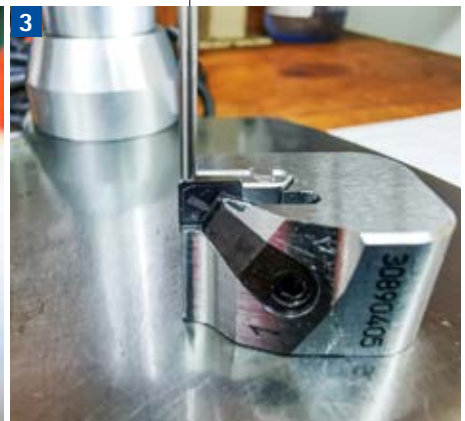
3 Bei der einfachen und schnellen Schneideneinstellung der Außenreibahle mit EasyAdjust-System dient die flache Unterseite der Kassette als Referenzfläche.
