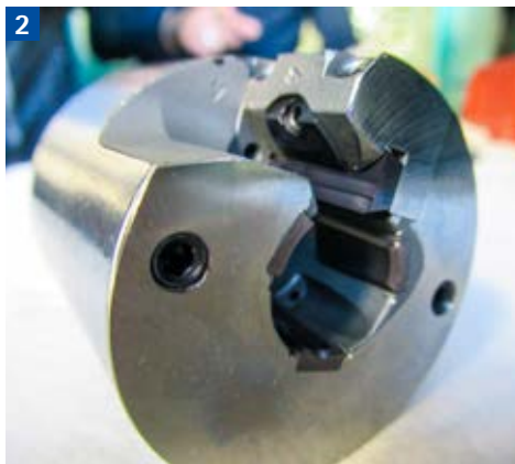
2 Das konventionelle Werkzeug für das Außenreiben mit drei Führungsleisten und der einschneidigen Wendeschneidplatte.
