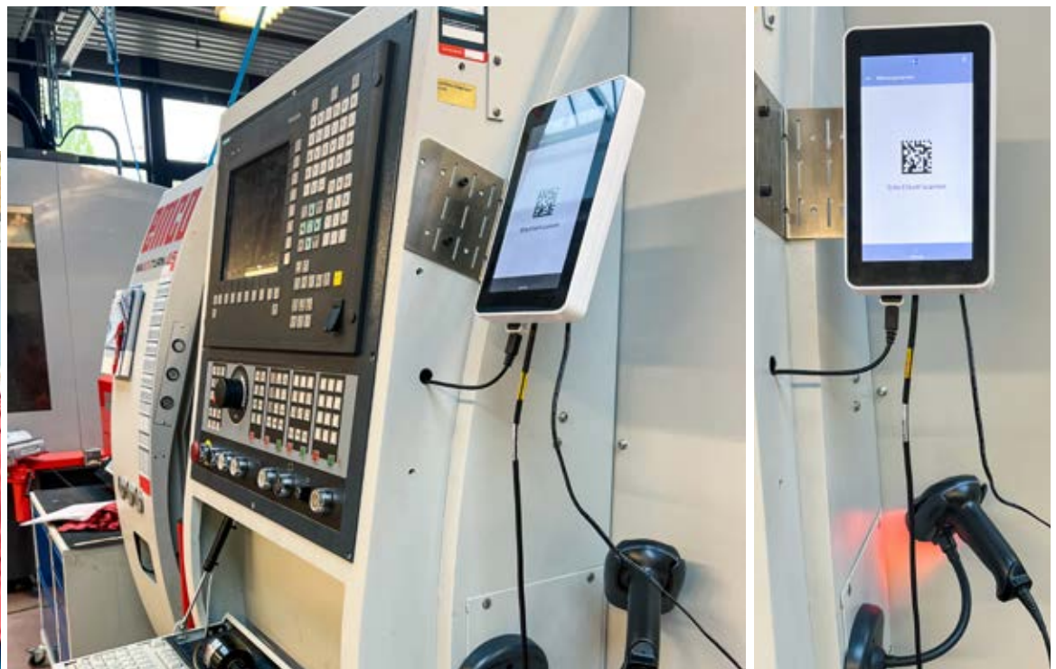
Zwei der EMCO Maschinen sind mit c-Connect Boxen ausgestattet, um Daten per Scan an die Maschine übertragen zu können.
