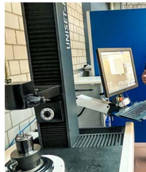
Unterricht direkt am Einstellgerät: Harald Wöhrle (links) bespricht mit dem angehenden Techniker Manuel Boaretti, wie Werkzeuge vermessen werden.
