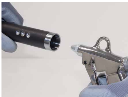
2. 用压缩空气和抹布对可换头刀柄的锥面、螺纹和端面进行清洁。
