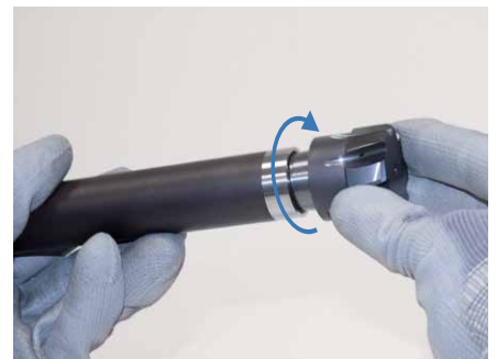
3. 用手把可换铰刀头顺时针拧紧到可换头刀柄中。接着把可换头刀柄连同刀具一起夹紧到机器夹头中。
