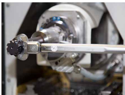
5. 借助于扭矩扳手和相配的插头开口扳手用给定的拧紧力矩把可换铰刀头拧紧（见表“可换铰刀头的拧紧力矩”）。
