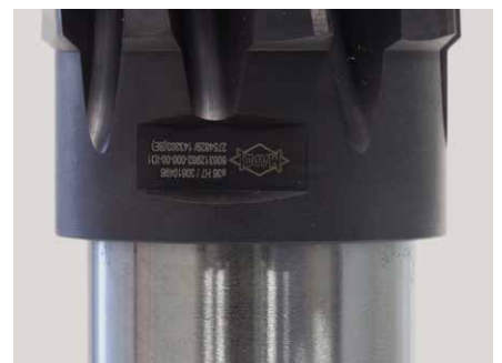
结果： 在可换铰刀头和可换头刀柄之间的间隙被封闭，形成一个力和形状吻合的连接。可换铰刀头 CPream 现在已经可以使用。
