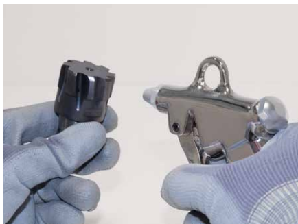
1. 用压缩空气和抹布对可换铰刀头的锥面、螺纹和端面进行清洁。
