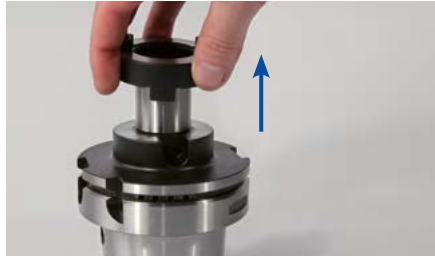
1. Extraer el anillo arrastrador del portafresa.
