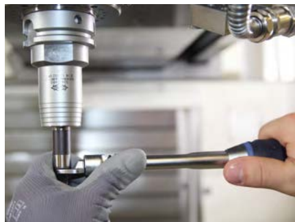
5. Nota: Colocar la mano libre en el cabezal de fresado intercambiable para poder realizar una adaptación precisa. De este modo, puede ajustarse con mayor precisión el par de apriete.
