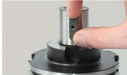
2. Colocar la chaveta en el portafresa.
